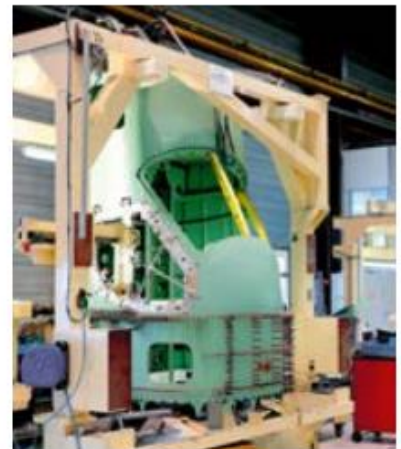
Die Cockpitsektionen der TBM werden in senkrechter Lage gebaut.
