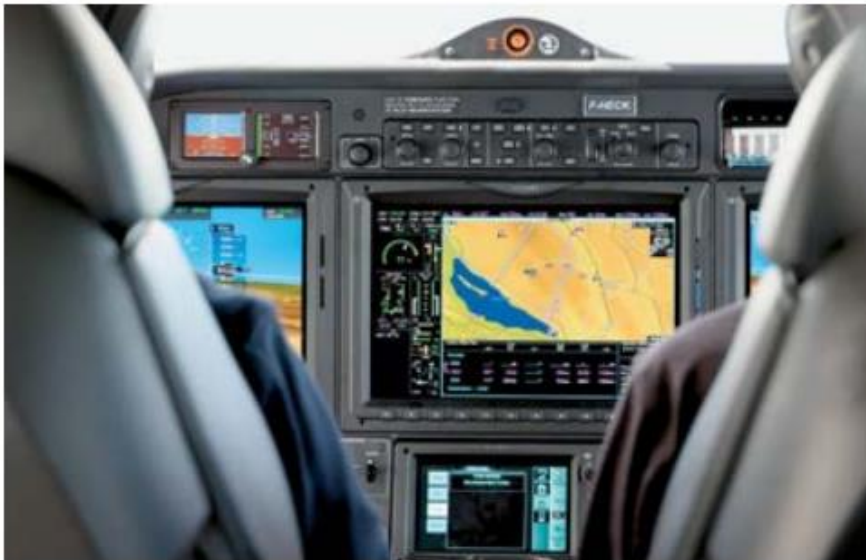
Das Garmin-3000-Cockpit der TBM 940 mit dem orangefarbenen «Homesafe»-Knopf in der Mitte.
